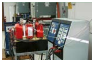
Brennstoffzellentest mit einer DC-Quelle von AeroVironment
